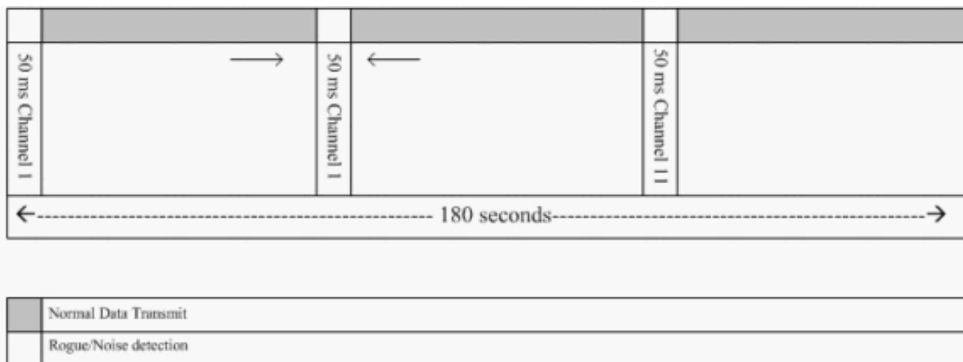
Según lo ilustrado, un número alto de canales configurados para ser analizado combinó con los intervalos cortos de la exploración, deja menos hora para el AP realmente a los clientes de los datos de servicio.
