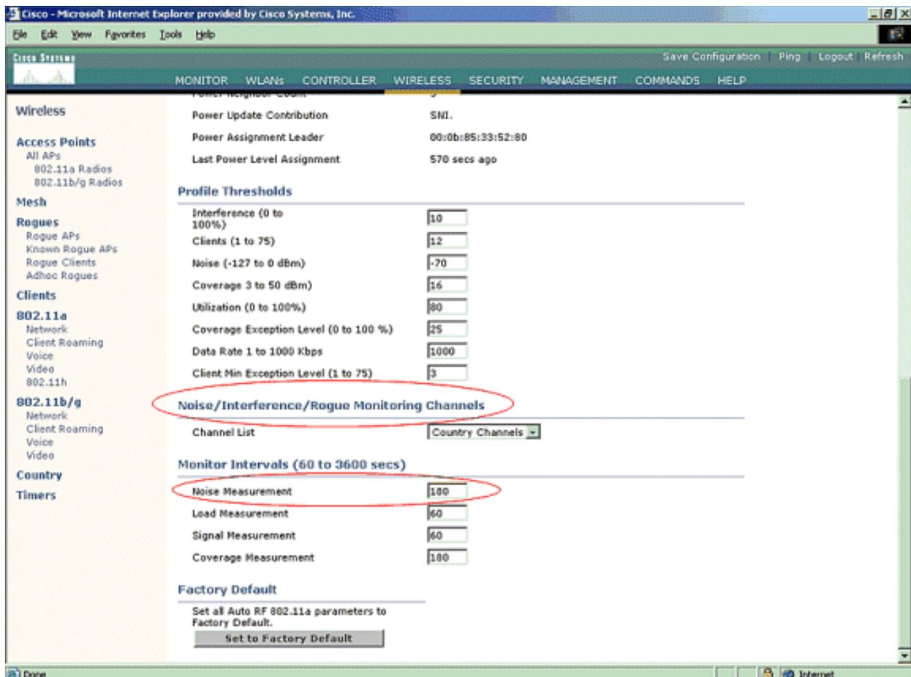
La lista del canal detalla los canales que se analizarán para la supervisión rogue, además del otro regulador y de las funciones AP. Refiera al [Lightweight Access Point FAQ](#) para más información sobre los AP ligeros, y al [Troubleshooting FAQ del regulador del Wireless LAN \(WLC\)](#) para más información sobre los reguladores
