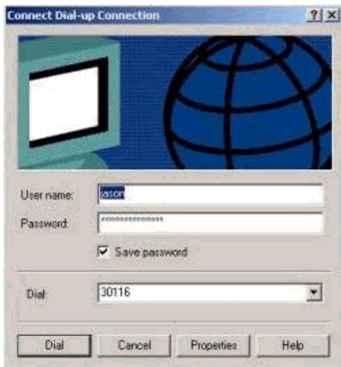
Después de establecer la conexión de acceso telefónico, se asigna una dirección IP del conjunto de marcado configurado en el router. Podemos verificar esto ejecutando el comando **ipconfig** en el host. Se muestra como un adaptador PPP en el host.
