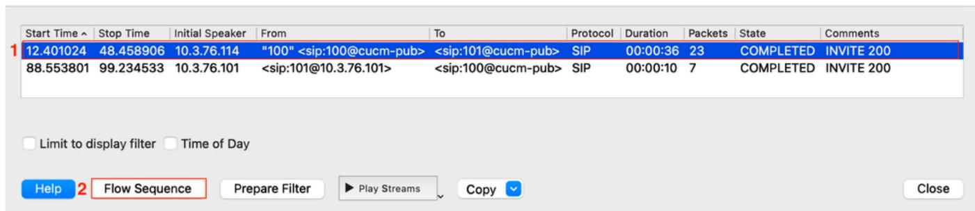
7. Wireshark muestra el diagrama de flujo de llamadas desde la perspectiva del dispositivo.
