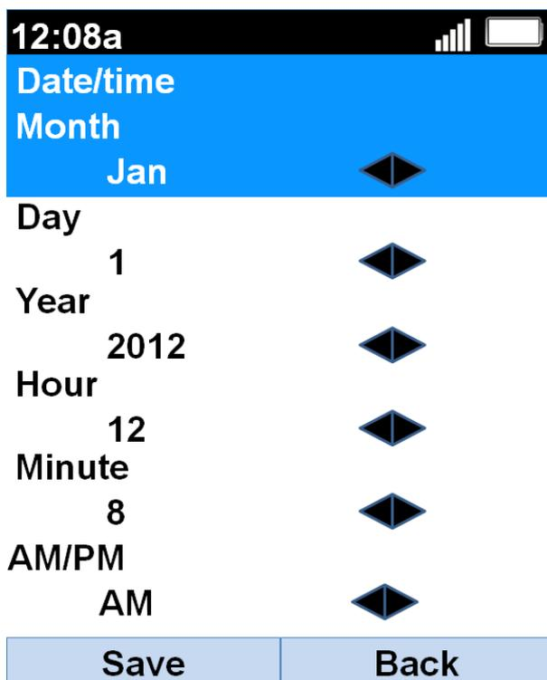
Paso 3. Utilice los botones de navegación **izquierda** y **derecha** para cambiar el valor de cada campo.
