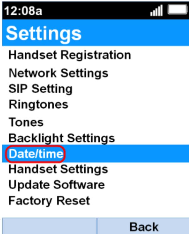
Paso 2. En el menú Settings, elija **Date/time** con el uso de los botones de navegación arriba y abajo y presione el botón **Select**.
