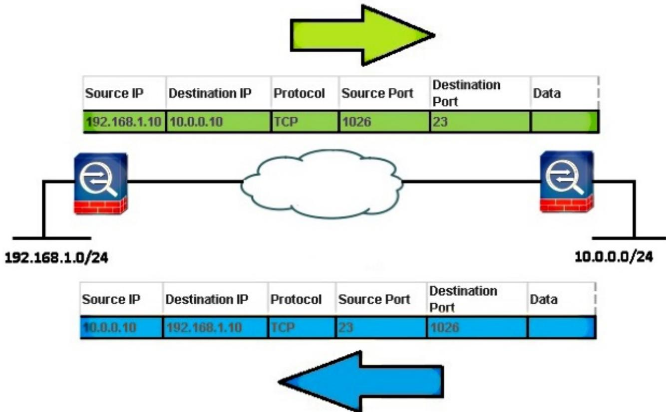
Nota: El eq 23 192.168.1.0 255.255.255.0 tcp 10.0.0.0 255.255.255.0 del permiso de la lista de acceso vpnfilt-l2l de ACE también permite que la red remota inicie una conexión a la red local en cualquier puerto TCP si utiliza un puerto de origen de 23.
