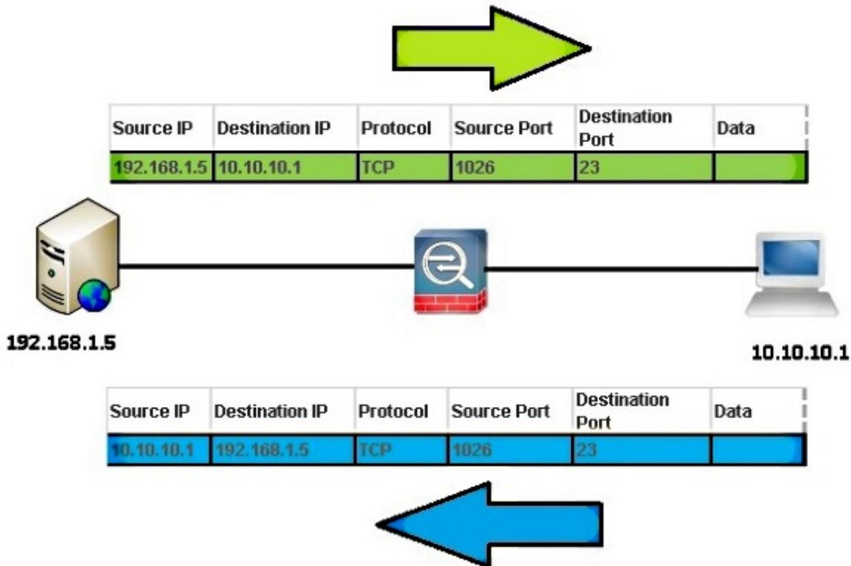
Nota: El eq 23 192.168.1.0 255.255.255.0 tcp 10.10.10.1 255.255.255.255 del permiso del vpnfilt-ra de la lista de acceso de ACE también permite que el cliente RA inicie una conexión a la red local en cualquier puerto TCP si utiliza un puerto de origen de 23.
