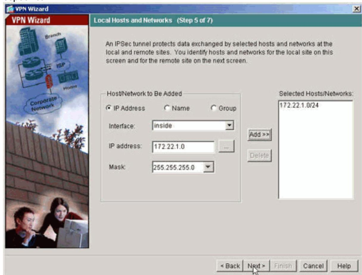
11. Los host y las redes en el lado remoto del túnel se especifican.
