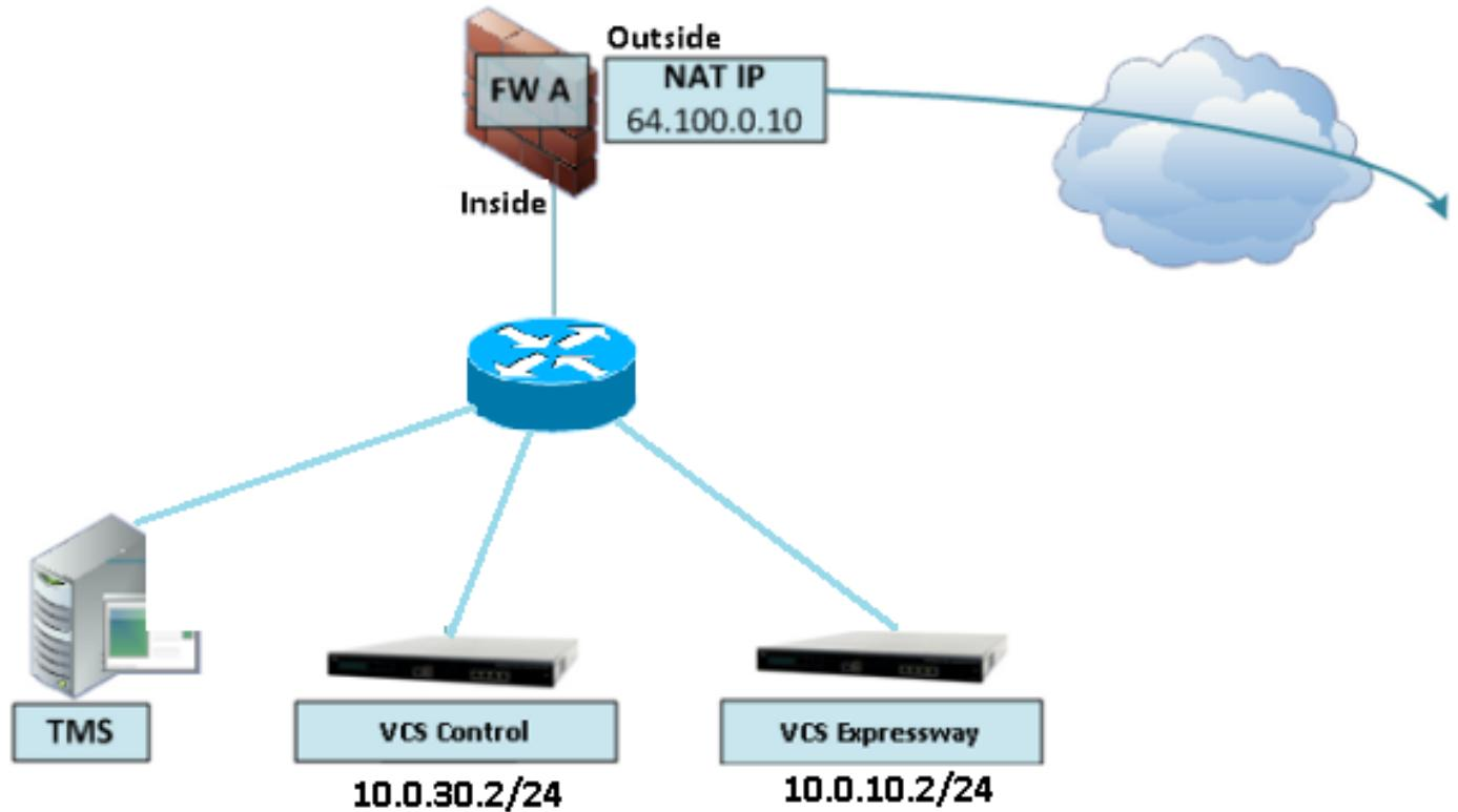
Este tipo de implementación requiere que la dirección IP del control de VCS se traduzca a la dirección IP interna del ASA para obligar al tráfico de retorno a regresar al ASA para evitar problemas de ruta asimétrica para la reflexión de NAT.
