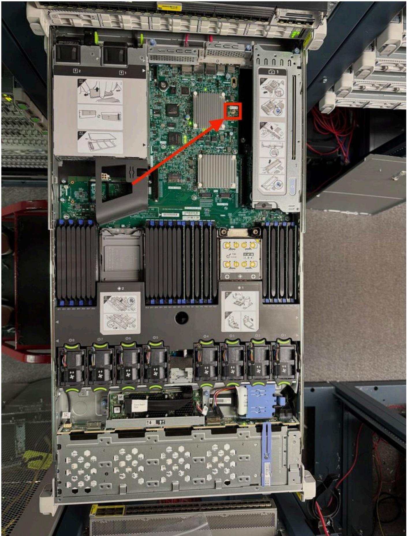
Imagen 1. Ubicación del módulo TPM en el dispositivo SNS 3700 Series
