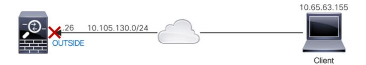
Una ACL se configura con la palabra clave **control-plane** para bloquear el tráfico "to-the-box" originado en la dirección IP 10.65.63.155 y destinado a la dirección IP de la interfaz 'externa' del ASA.
