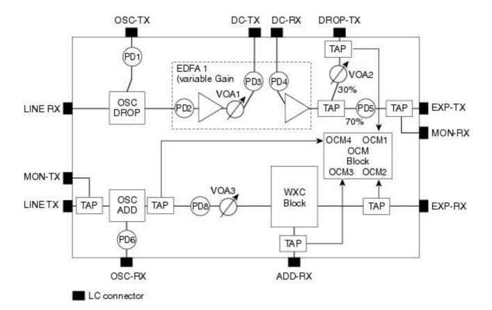
Como se muestra en este diagrama, no hay unidad de amplificador entre EXP-RX y el puerto LINE-TX. El puerto Line-TX transmite la alimentación óptica recibida en el puerto EXP-RX.
