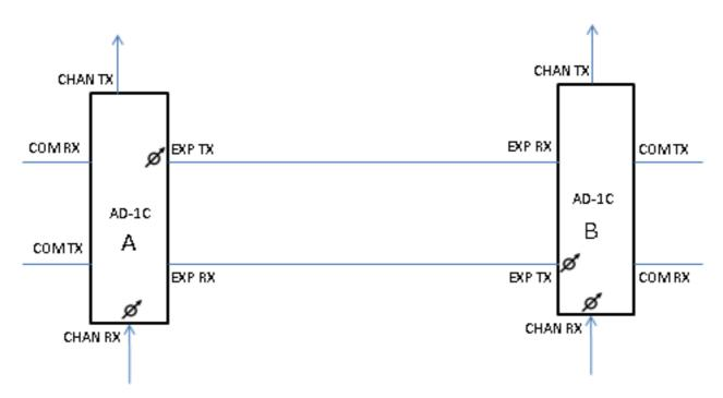
En el diagrama, puede entender que tiene VOA en los puertos EXP-TX y CHAN-RX, y lo mismo se aplica a todos los demás tipos de tarjetas. En el parámetro ANS, tiene un punto establecido de COM-RX y COM-TX.
