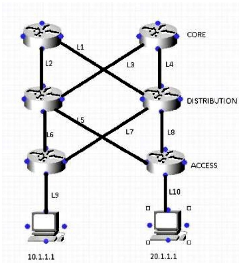
Asuma que para alcanzar la red 10.1.1.1 del [Top Left] del router1 (r1), hay dos links de costo equivalente (L1, L2). Se utiliza la decisión sobre la cual de los dos conecta es hecha por un algoritmo de troceo. Por abandono, el IP de la fuente (SORBO) y el IP de destino (INMERSIÓN) se utilizan como los parámetros en el algoritmo de troceo.
