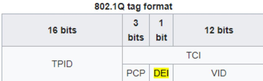
**TPID:** Identificador de protocolo de etiqueta: establecido en un valor 0x8100 para identificar la trama como una trama etiquetada Dot1Q
