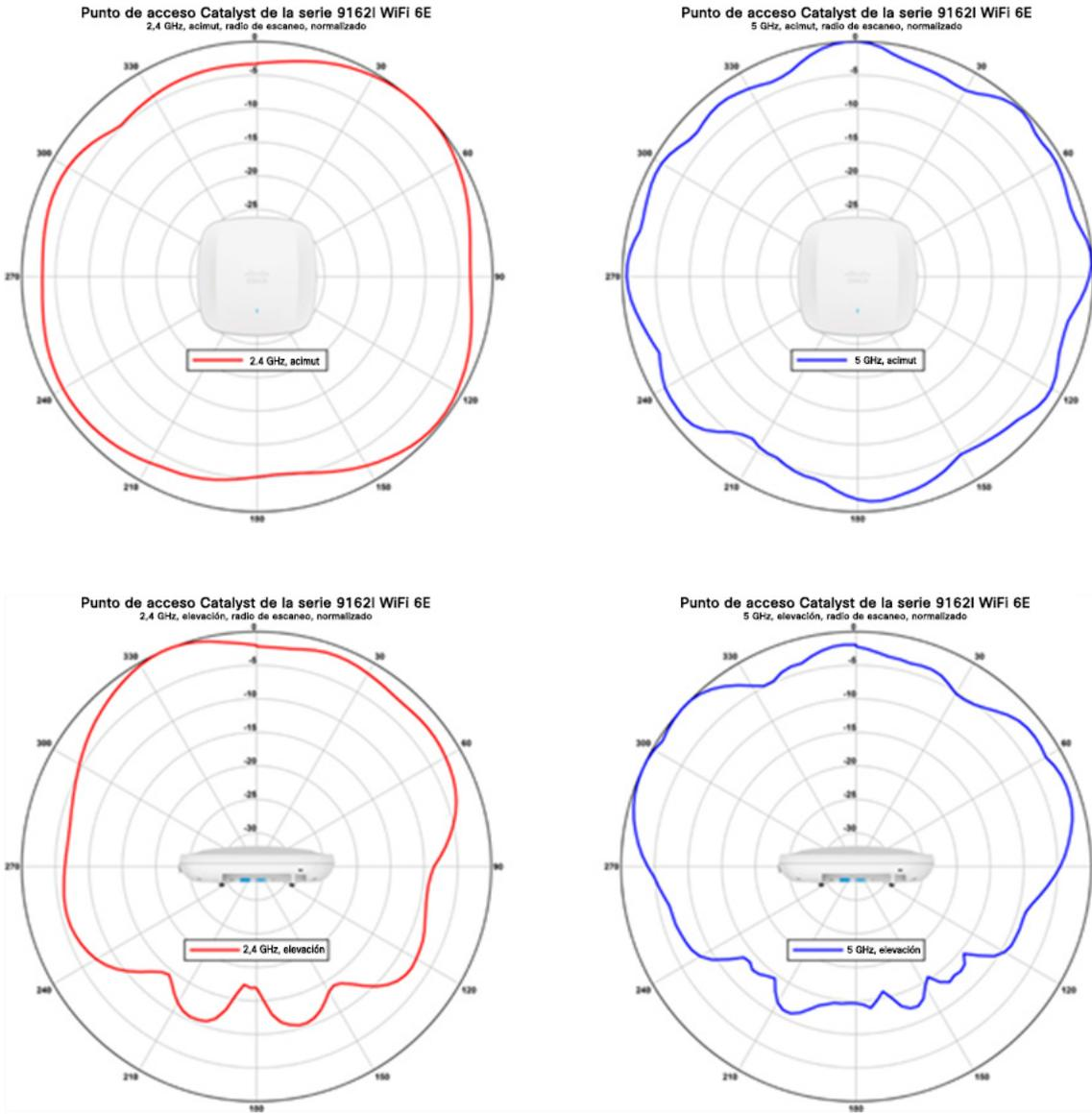
**Figura 4.** Patrones de antena para radios de escaneo Catalyst 9162I de 2,4 GHz y 5 GHz
