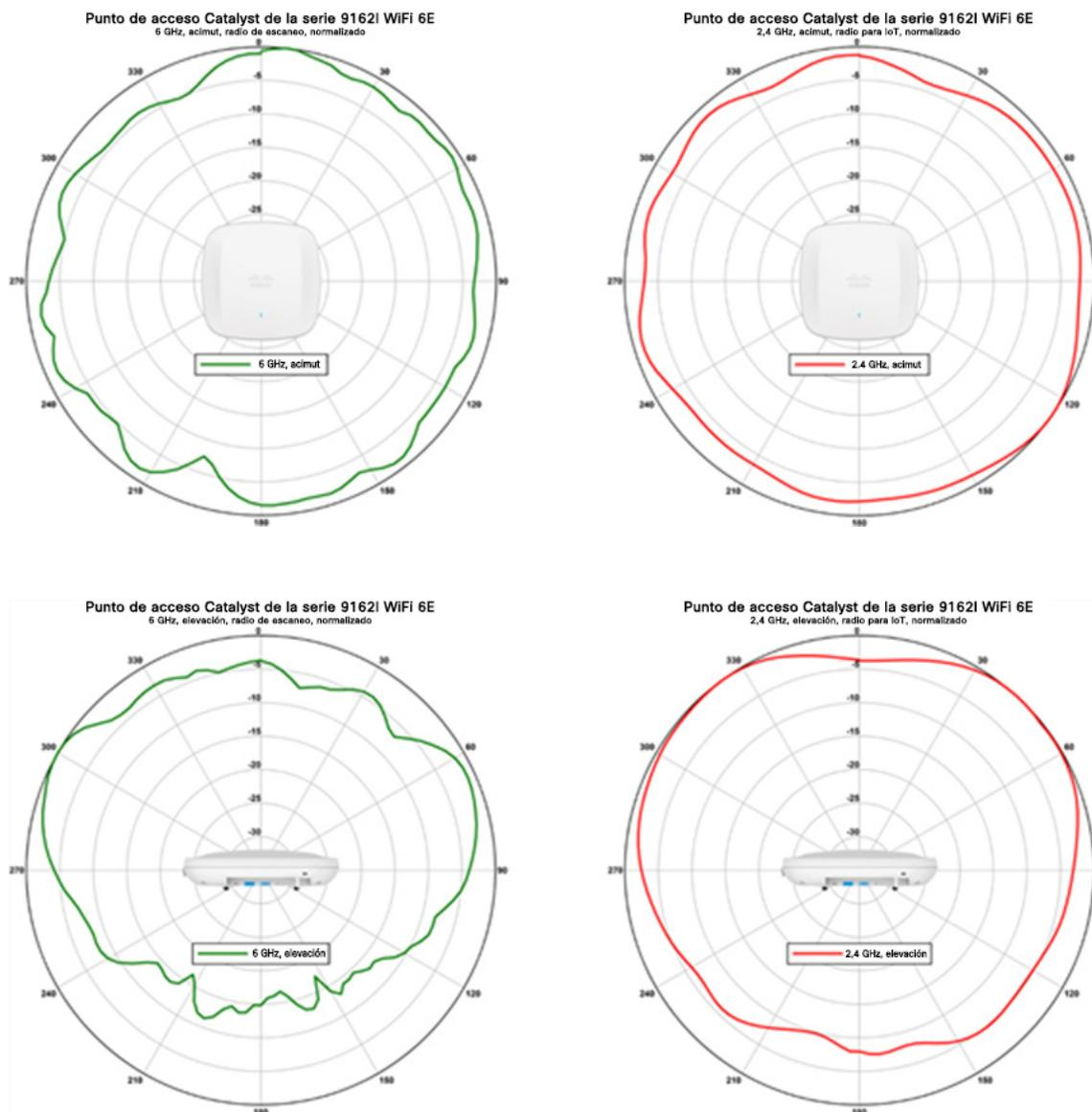
**Figura 5.** Patrones de antena para la radio de escaneo de 6 GHz Catalyst 9162I y la radio de IoT de 2,4 GHz
