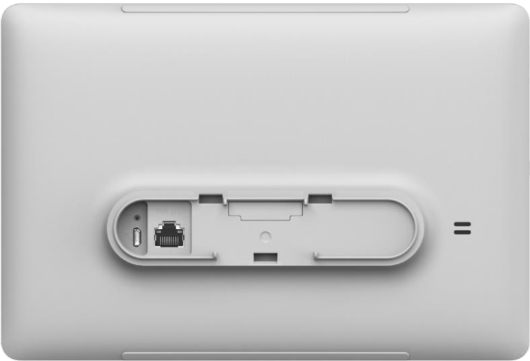
Arriba: La sección de E/S de Cisco Room Navigator para mesa con el soporte de pie separado del panel táctil.
