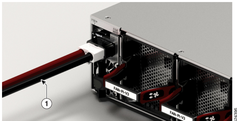
Figura 69: Conexión de la alimentación de CC: Cisco 8712-MOD-M
