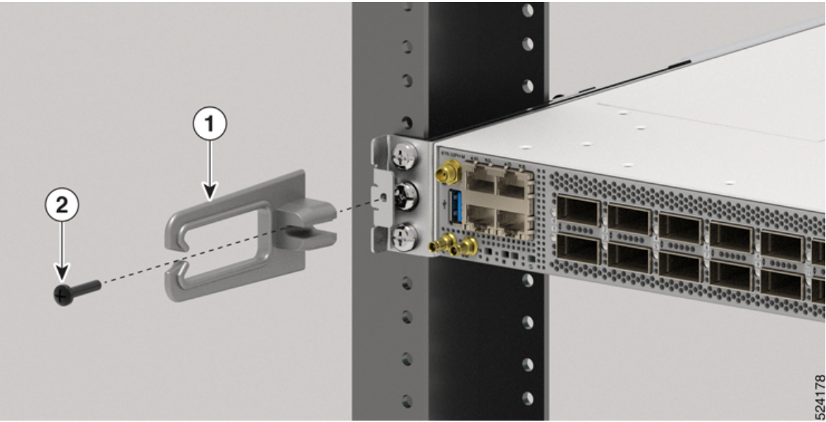
Figura 63: Instalación del soporte de gestión de cables en el router Cisco 8711-32FH-M
