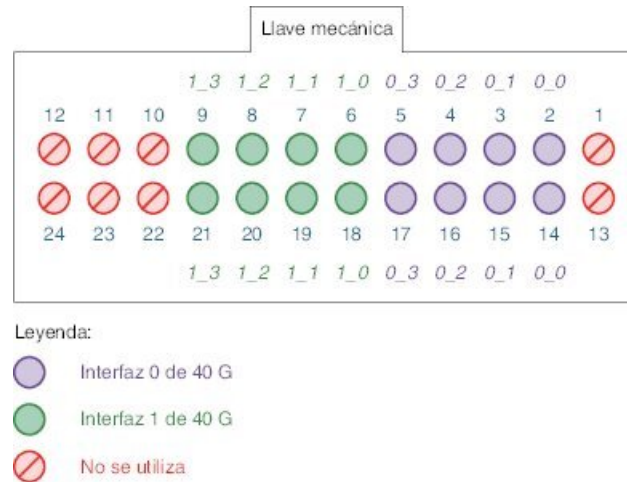
Figura 94: Diagrama de pines del conector de 100 Gigabit MPO-24 (modo 2 x 40)
