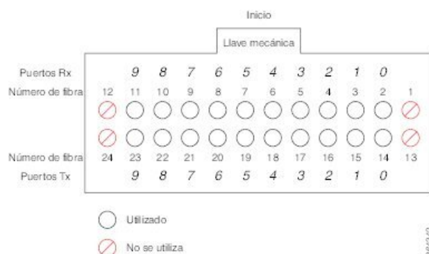
Figura 93: Diagrama de pines del conector de 100 Gigabit MPO-24
