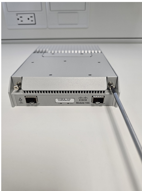
Figura 12: Afloje los tornillos
