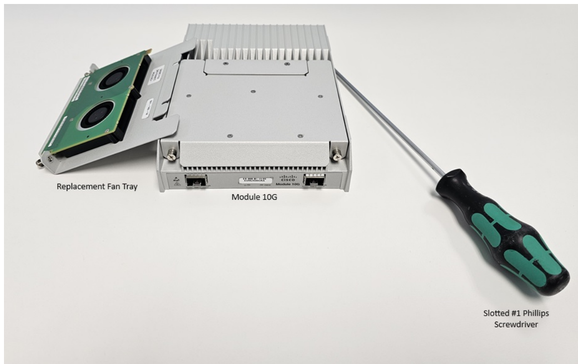
Figura 11: Artículos de repuesto de la bandeja del ventilador
