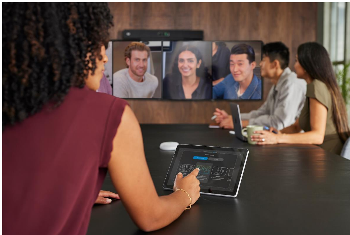
Encima: Cisco Room Navigator para mesa utilizada como controlador táctil en una implementación Cisco Room Bar Pro
