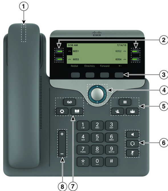
Abbildung 6: Tasten und Funktionen der Cisco IP-Telefon 7800-Serie
