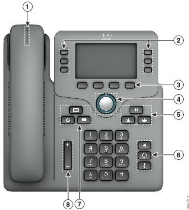
Abbildung 5: Multiplattform-Telefone Cisco IP-Telefon 6871 Tasten und Funktionen
