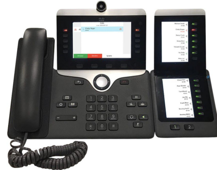
Abbildung 7: Cisco IP-Telefon 8865-Tastenerweiterungsmodul mit zwei Bildschirmen
