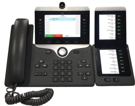
Abbildung 5: Cisco IP-Telefon 8865-Tastenerweiterungsmodul mit zwei Bildschirmen
