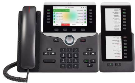
Abbildung 4: Cisco IP-Telefon 8851/8861-Tastenerweiterungsmodul mit zwei Bildschirmen
