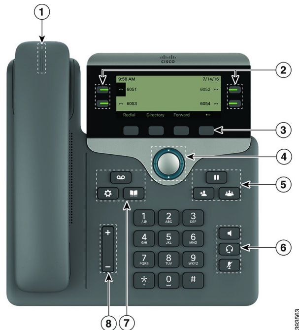
Abbildung 1: Tasten und Funktionen der Cisco IP-Telefon 7800-Serie
