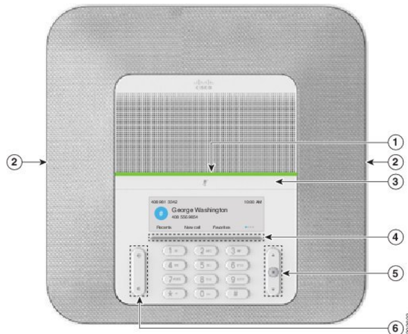
Abbildung 2: Tasten und Funktionen des Cisco IP-Konferenztelefon 8832
