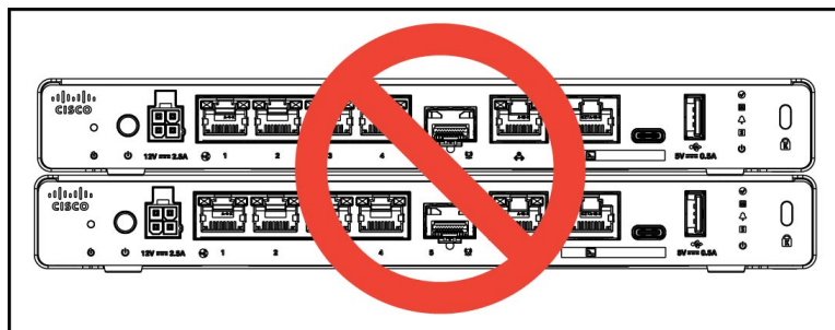
Abbildung 5: „Nicht stapeln“-Kennzeichnung am Chassis
