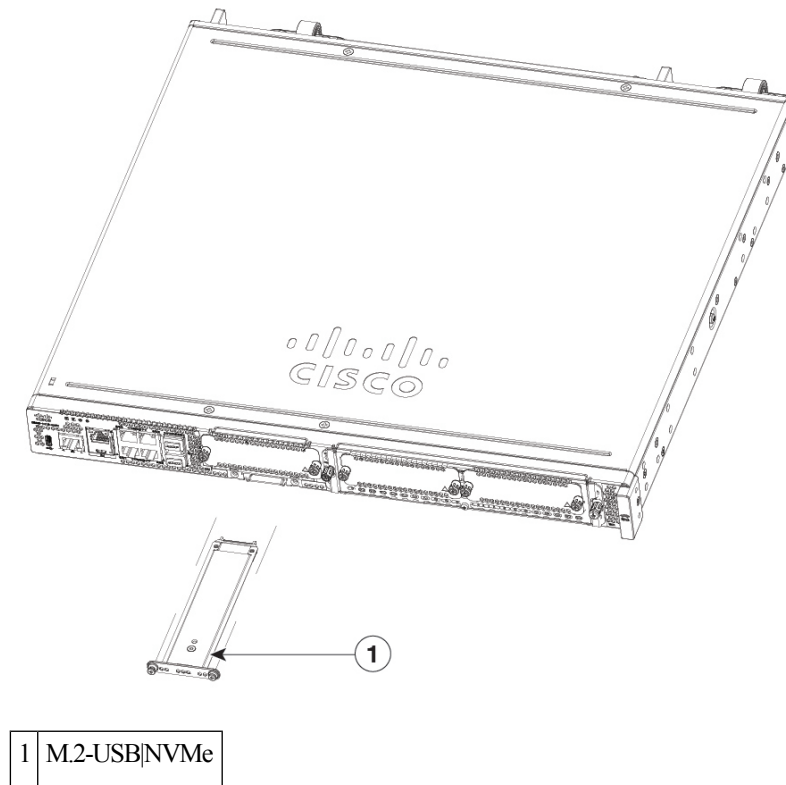
Abbildung 63: Installieren des M.2-USB/NVMe-Moduls (C8375-E-G2)
