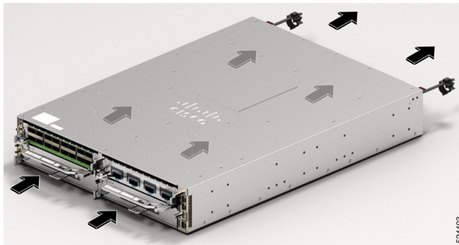
Abbildung 18: Luftstromrichtung für Cisco 8712-MOD-M-Router in PSE-Konfiguration
