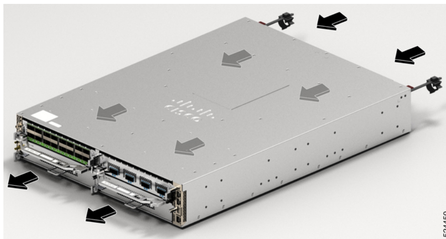
Abbildung 18: Luftstromrichtung für Cisco 8712-MOD-M-Router in PSE-Konfiguration
