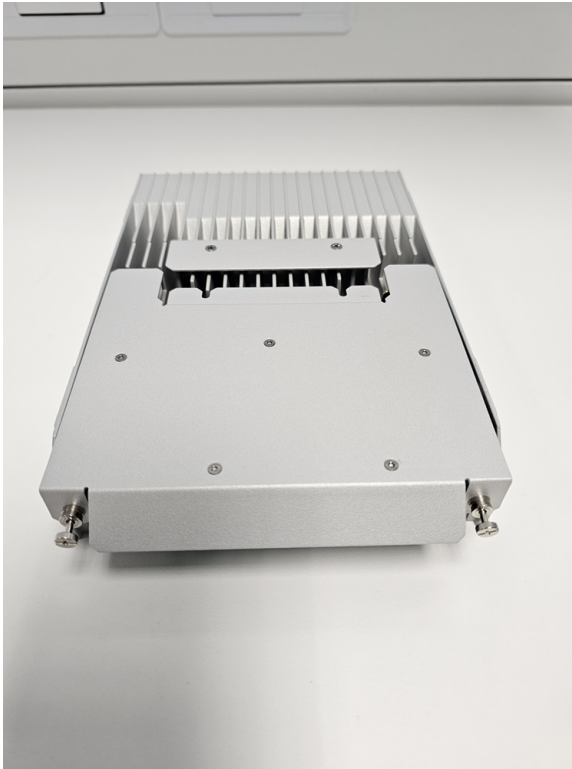
Abbildung 5: Ersatz-Lüftereinschub in das 10G-Modul schieben
