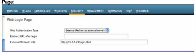
**Einschränkungen:**Für die Webauthentifizierung (intern oder auf einem externen Server) muss sich der Flex AP im Connected-Modus befinden. Die Webauthentifizierung wird nicht unterstützt, wenn sich Flex AP im Standalone-Modus befindet. Die Webauthentifizierung
