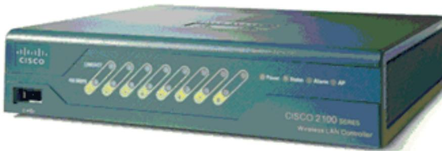
Der 2100 Controller wird mit einem externen Netzteil betrieben, das Strom aus einer Steckdose (100 bis 240 V Wechselstrom, 50 bis 60 Hz) aufnehmen kann.
