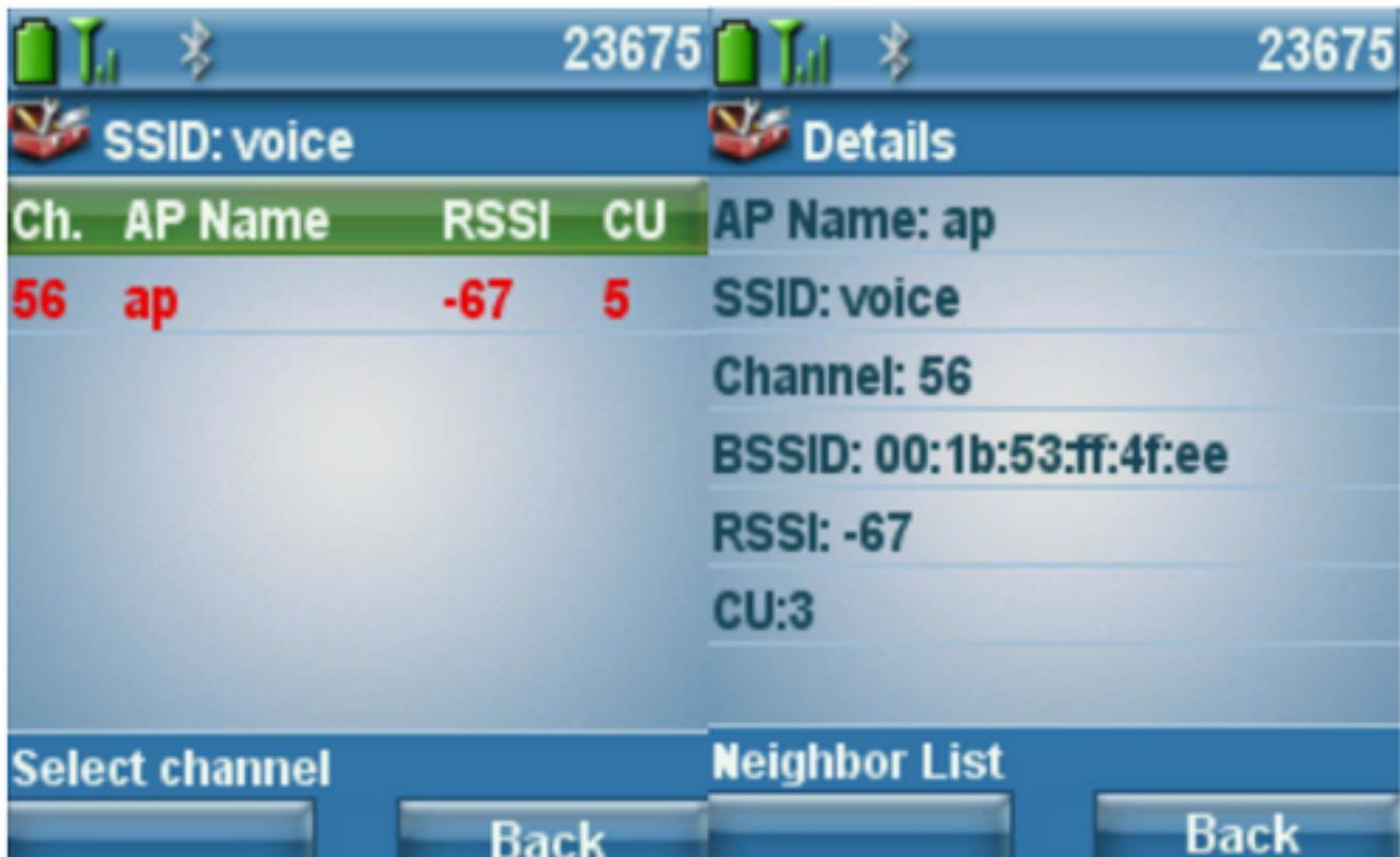
**Hinweis:** Die in Abbildung 22 gezeigte Kennzahl für die Kanalauslastung (CU) bezieht sich auf den QoS-Index (Enhanced Basis Service Set) mit einem Höchstwert von 255.
