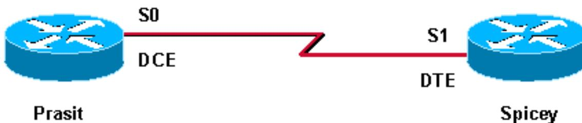
Die standardmäßige serielle Kapselung auf Cisco Routern ist Cisco HDLC. Sie muss daher nicht explizit auf dem Router konfiguriert werden. Daher wird der Kapselungstyp nicht in der Konfiguration angezeigt.
