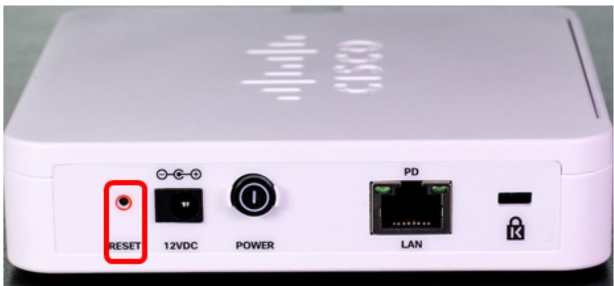
Schritt 2: Lassen Sie die Reset-Taste los, wenn die LEDs wieder leuchten.
