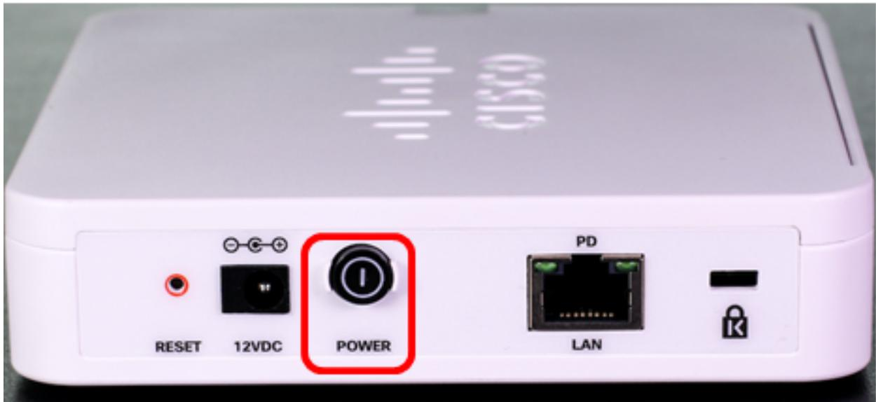
**Hinweis:** Die **POWER**-Taste funktioniert nur, wenn das Gerät ein Netzteil verwendet. Wenn die Stromversorgung über Power over Ethernet (PoE) erfolgt, ziehen Sie die Ethernet-Verbindung für drei Sekunden ab, und schließen Sie sie dann wieder an.
