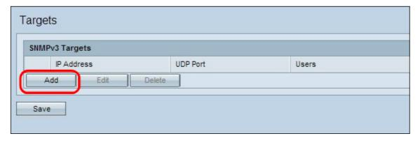
Schritt 2: Klicken Sie auf **Hinzufügen**, um ein neues SNMP-Ziel hinzuzufügen. Ein WAP-Gerät unterstützt maximal acht Ziele.
