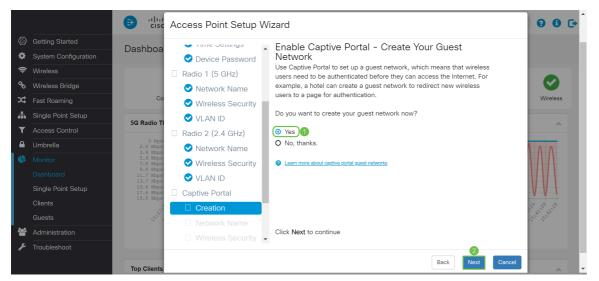
Schritt 16: (Optional) Wählen Sie das Optionsfeld aus, das dem *Radio* (*Funkmodul*) entspricht, in dem Sie das Gastnetzwerk platzieren möchten. Erstellen Sie dann im Feld *Gastnetzwerk* einen Netzwerknamen. Klicken Sie auf **Weiter**, um die *Wireless-*Sicherheitseinstellungen für das *Gastnetzwerk* zu konfigurieren.
