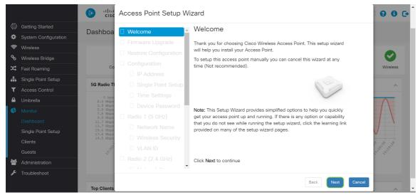
Hinweis: Wenn Ihr WAP bereits konfiguriert ist, Sie jedoch weiterhin auf den Installationsassistenten zugreifen möchten, navigieren Sie zu Getting Started > Setup Wizard (Erste Schritte > Installationsassistent). Das Fenster Access Point Setup Wizard (Assistent für Access Point-Einrichtung) wird angezeigt.
