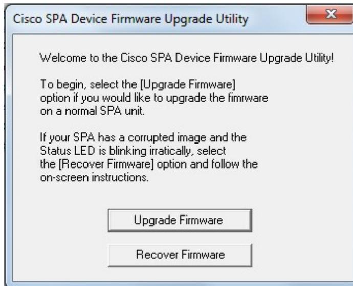
Schritt 8: Klicken Sie auf die Schaltfläche **Firmware aktualisieren**, um den Firmware-Upgrade-Prozess zu starten.
