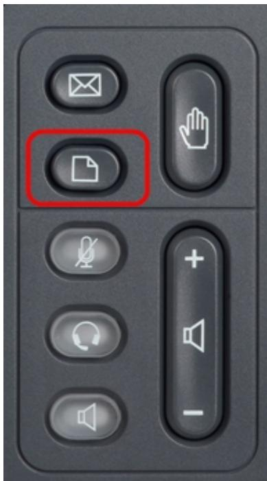
Schritt 1: Drücken Sie die **Setup**-Taste auf dem IP-Telefon, um das *Setup*-Menü aufzurufen.
