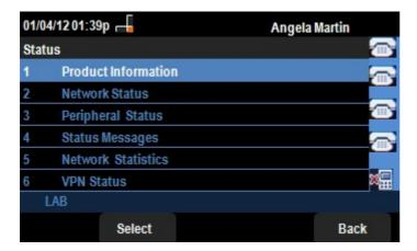
Schritt 3: Navigieren Sie mithilfe der Navigationstasten nach unten zu Peripheriestatus. Drücken Sie die programmierbare Taste **Select** (**Auswählen**). Das Menü "*Peripheriestatus*" wird angezeigt.
