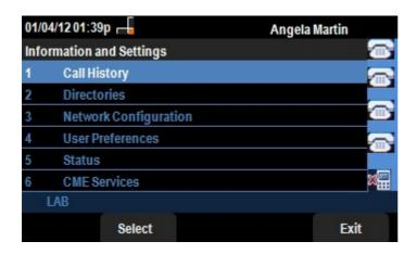
Schritt 2: Navigieren Sie mithilfe der Navigationstasten nach unten zu Status. Drücken Sie die programmierbare Taste **Select** (**Auswählen**). Das Menü *Status* wird angezeigt.
