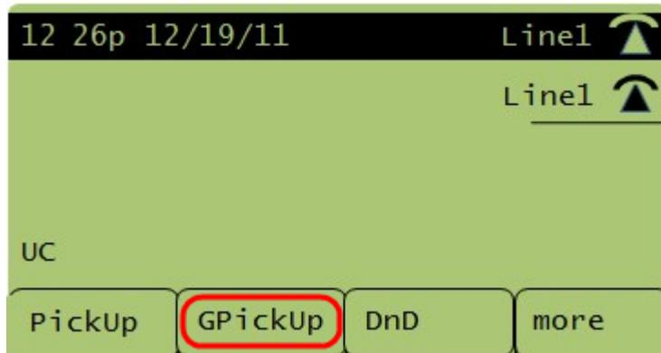
Schritt 1: Drücken Sie die programmierbare Taste **GPickUp**.
