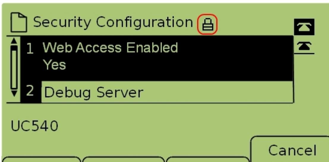
Schritt 4: Wenn oben im Bildschirm ein geschlossenes Vorhängeschloss angezeigt wird, drücken Sie **Star, Star, Pound** auf der Tastatur, um die Einstellungen zu entsperren, damit
