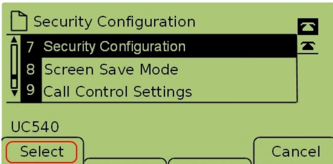
Schritt 3: Wählen Sie **Sicherheitskonfiguration aus**, und drücken Sie **Auswahl**, um das Menü *Sicherheitskonfiguration* aufzurufen.
