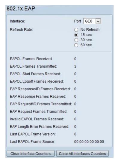
Schritt 2: Wählen Sie den Port aus der Dropdown-Liste im Feld "Interface" (Schnittstelle) aus, für den Sie die 802.1x EAP-Statistik anzeigen möchten.
