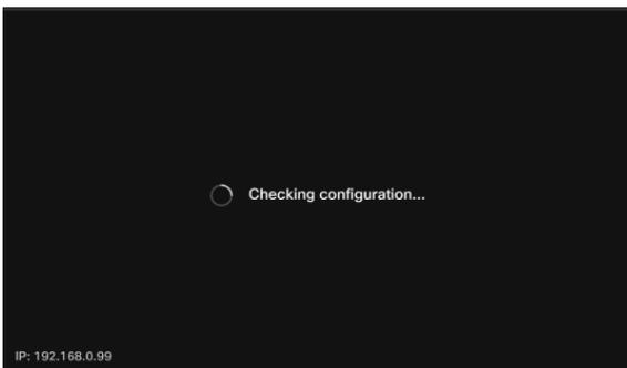
Das Telefon meldet sich dann bei den EDOS- (Enablement Data Orchestration System)/CDA-Servern (Customer Device Activation System) von Cisco an, um festzustellen, ob die MAC-Adresse protokolliert wurde. Falls vorhanden, wird die Konfiguration heruntergeladen.
