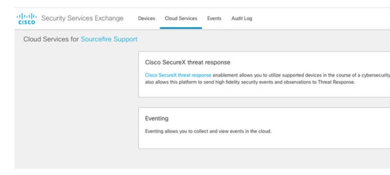
Schritt 3: Melden Sie sich beim FirePOWER Management Center an, navigieren Sie zu System>Integration>Cloud-Services, aktivieren Sie die Cisco Cloud Event Configuration, und wählen Sie die Ereignisse aus, die Sie an die Cloud senden möchten:
