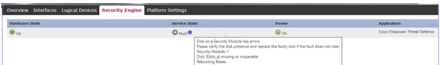
Empfohlene Aktion: Versuchen Sie, den SSD-Datenträger erneut einzusetzen. Wenn es nicht hilft, Chassis-Fehlerbehebung Paket sammeln und Cisco TAC kontaktieren.
