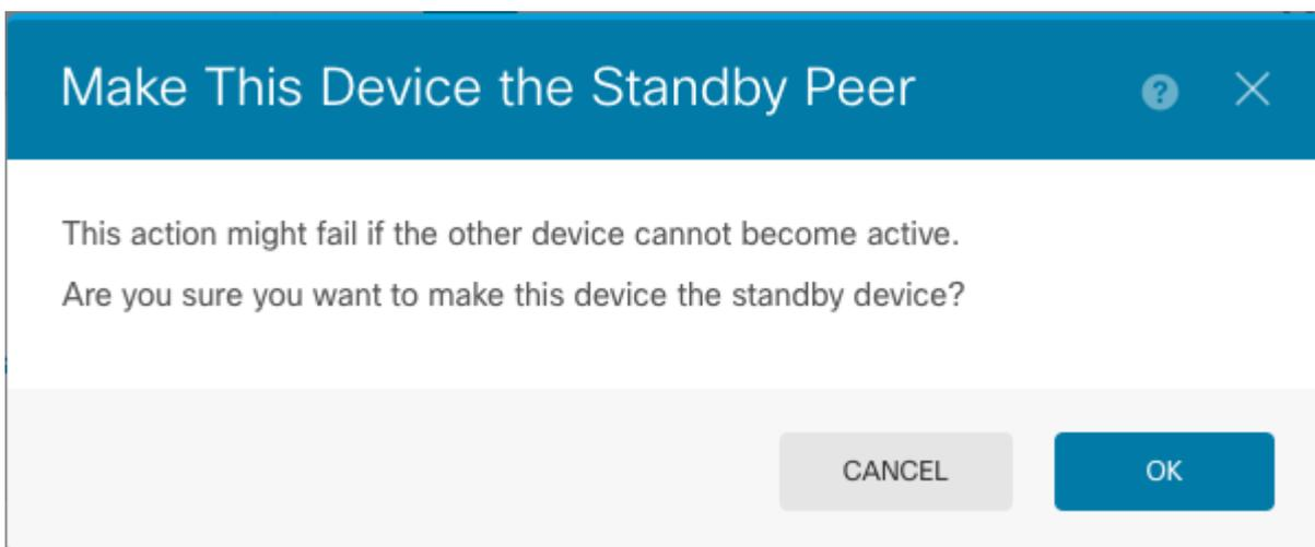
Das System erzwingt einen Failover, sodass das aktive Gerät in den Standby-Modus und das Standby-Gerät in das neue aktive Gerät wechselt.
