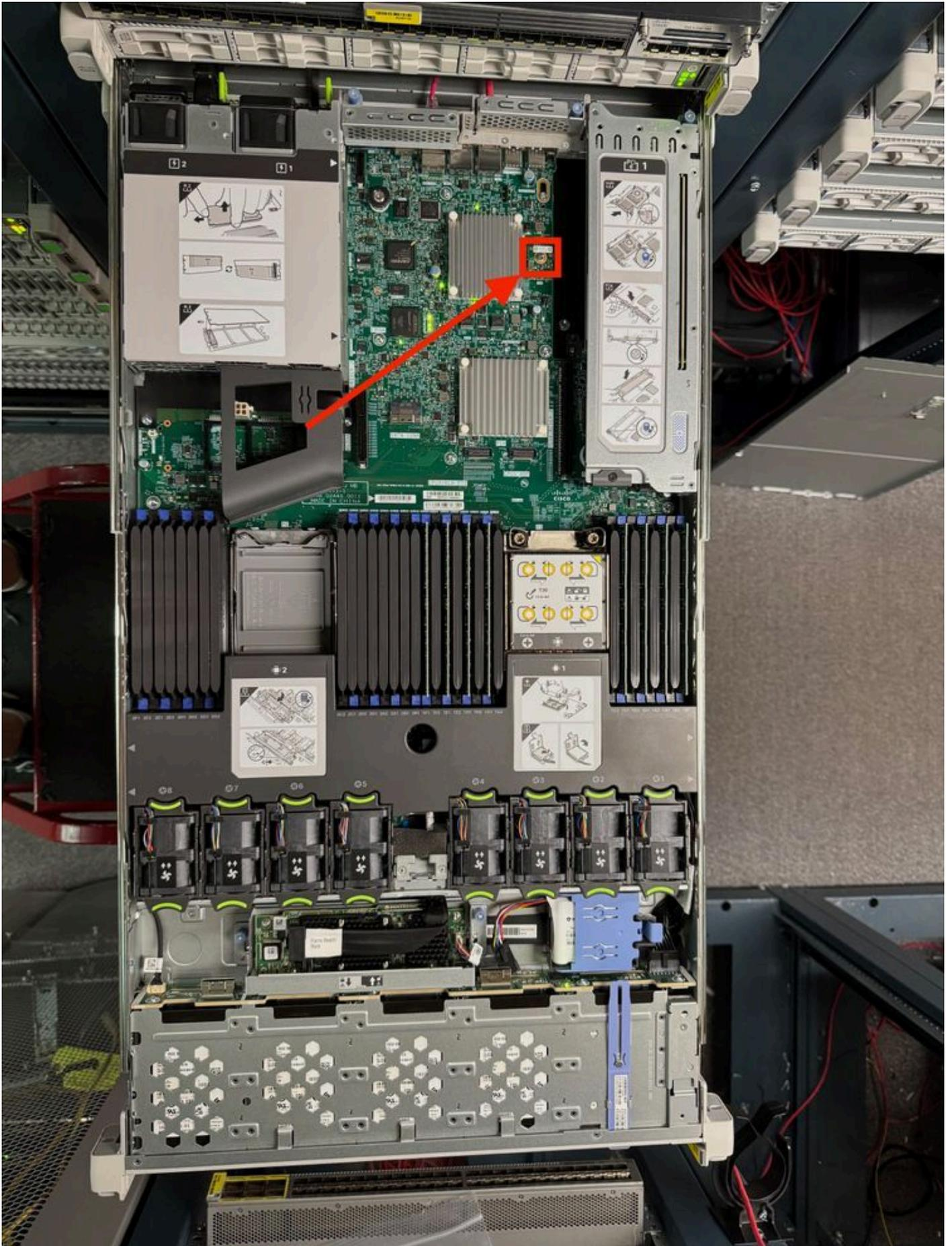
Abbildung 1: Position des TPM-Moduls in der Appliance der Serie SNS 3700
