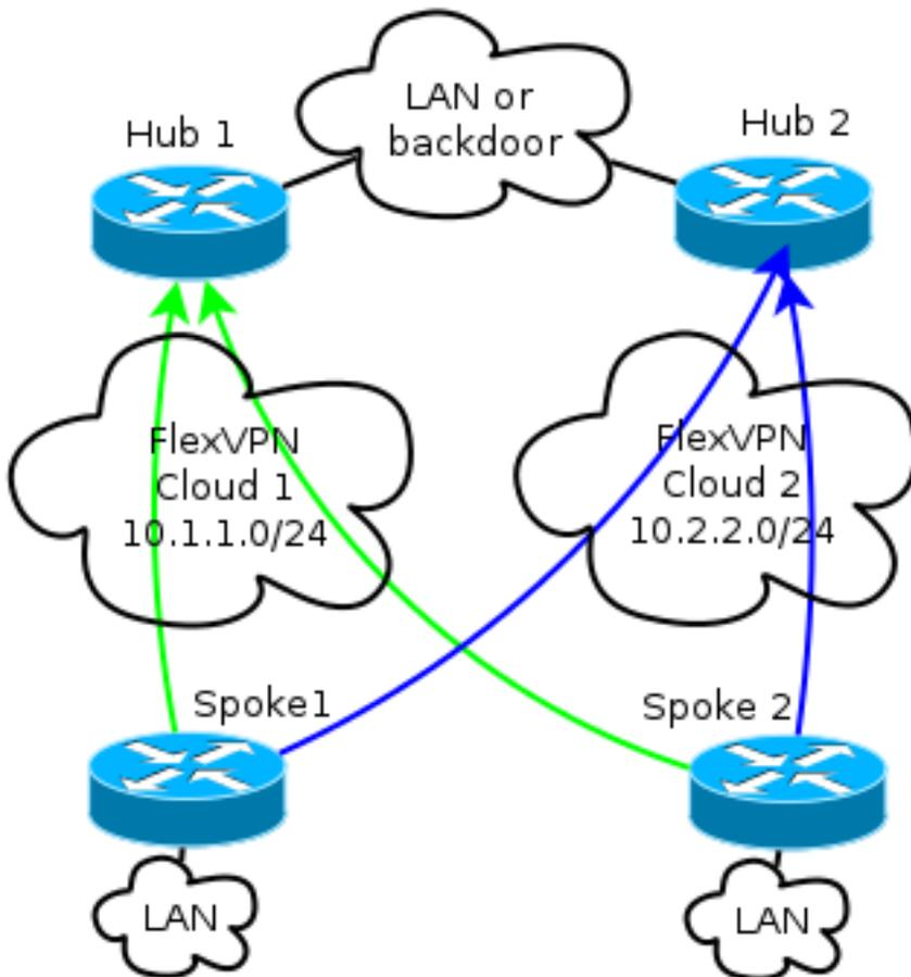
**Hinweis:** Die grünen Linien im Diagramm zeigen die Verbindung und Richtung der Internet Key Exchange Version 2 (IKEv2)/Flex-Sitzungen mit Hub 1 an, und die blauen Linien zeigen die Verbindung mit Hub 2 an.
