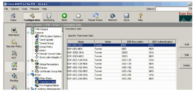
2. Gehen Sie wie folgt vor, um einen Transformationssatz hinzuzufügen: Geben Sie einen Namen für den Transformationssatz ein. Wählen Sie die Methoden ESP Encryption und ESP Authentication aus. Wählen Sie den Modus als **Transport** aus. Klicken Sie auf
