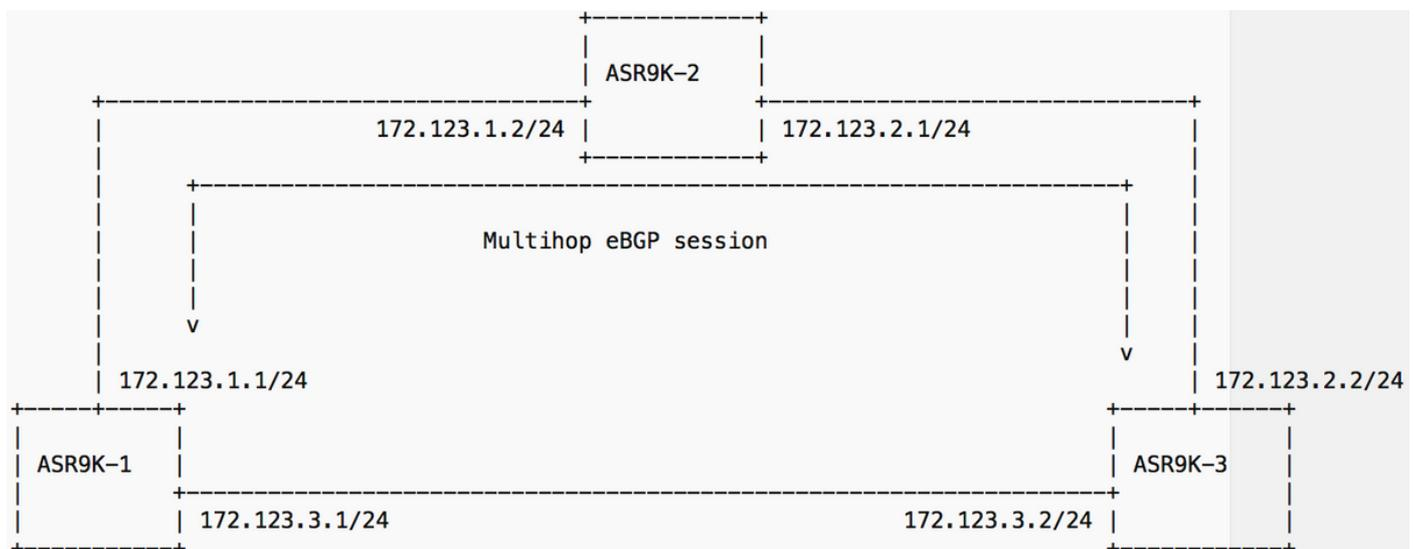
Sie können die direkte Verbindung zwischen ASR9K-1 und ASR9K-3 **beenden**. Anschließend sind die Peer-Adressen über den ASR9K-2 erreichbar, der die Multihop-Verbindung darstellt. Der Ping-
