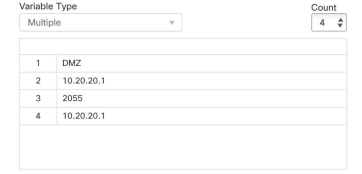
Fügen Sie in Schritt 4 die Konfigurationsposition hinzu: flow-export destination \$netflow\_Destination.get(0) \$netflow\_Destination.get(1) \$netflow\_Destination.get(2)
