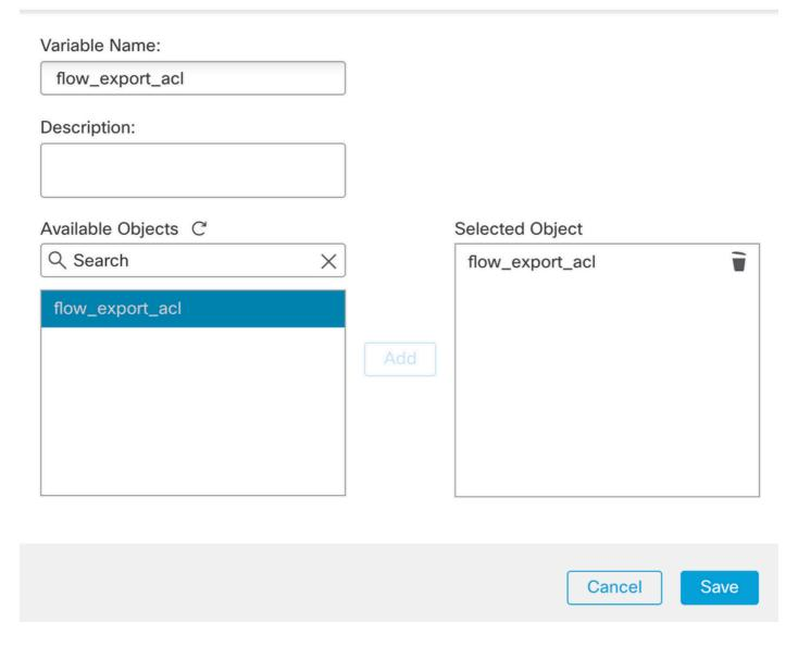
Fügen Sie die nächsten Konfigurationsposten in das leere Feld rechts ein, und fügen Sie die zuvor definierte Variable (**\$flow\_export\_acl.**) in die Konfigurationsposition der Übereinstimmungszugriffsliste ein.
