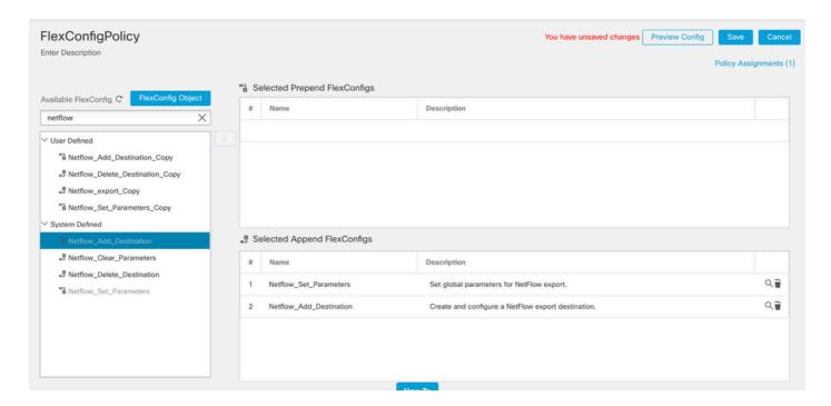
**Hinweis**: Einen zweiten NSEL-Collector hinzufügen, an den NetFlow-Pakete gesendet werden. Fügen Sie in Schritt 1 vier Variablen hinzu, um die zweite Netflow Collector-IP-Adresse hinzuzufügen.
