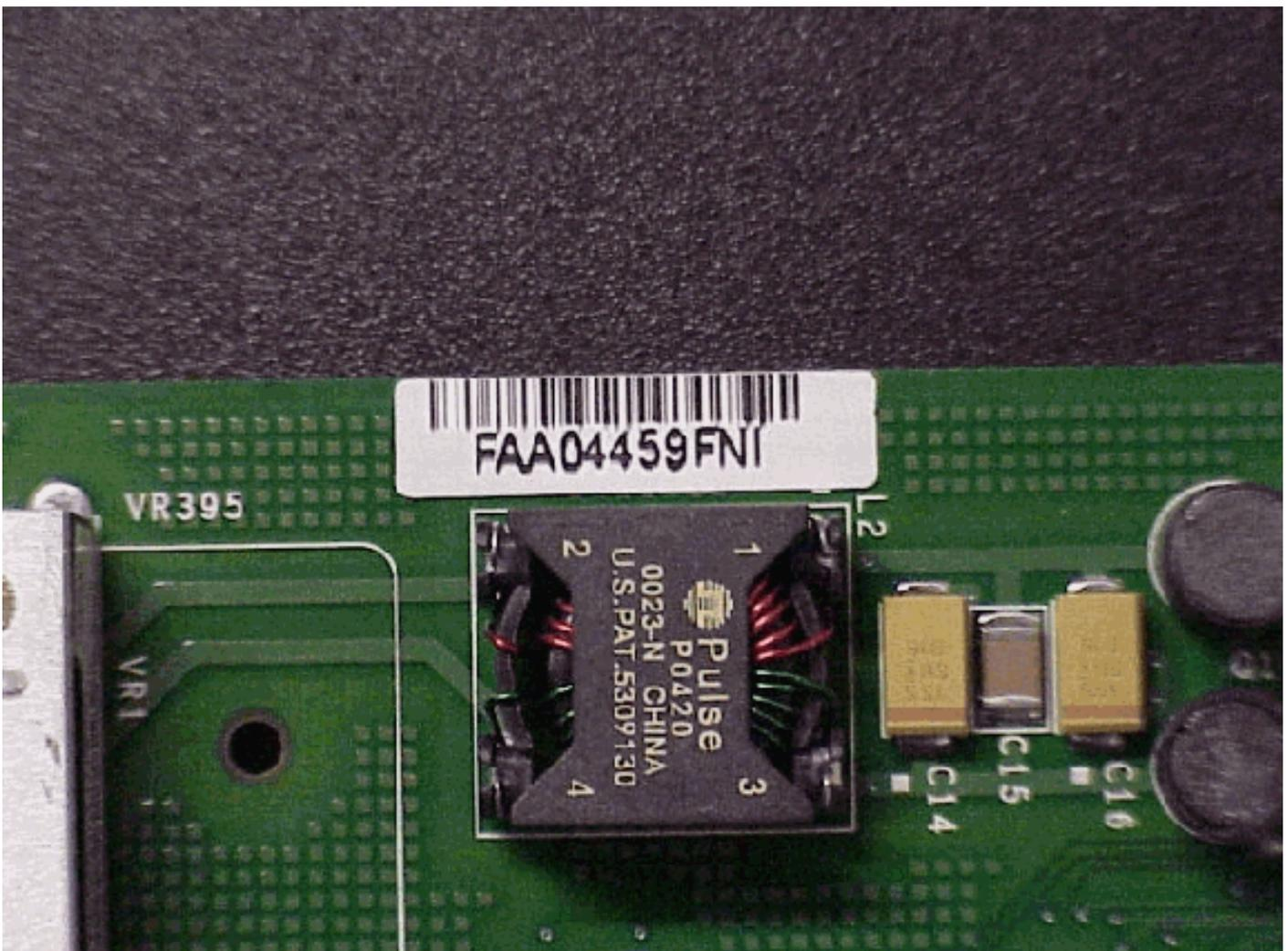
**Hinweis:** Bei älteren Mainboard-Assemblies (vor Cisco) befindet sich das Serien- oder Teilenummernetikett an derselben Stelle wie das Cisco Produkt. Das Format der Seriennummer und der Teilenummer ist jedoch unterschiedlich. Die Seriennummer besteht aus sechs Ziffern (z. B. 123456) und die Teilenummer beginnt mit der Nummer 87 oder 89 (z. B. 87-31-0005). In diesem Feld sind nur wenige dieser Assemblies enthalten.
