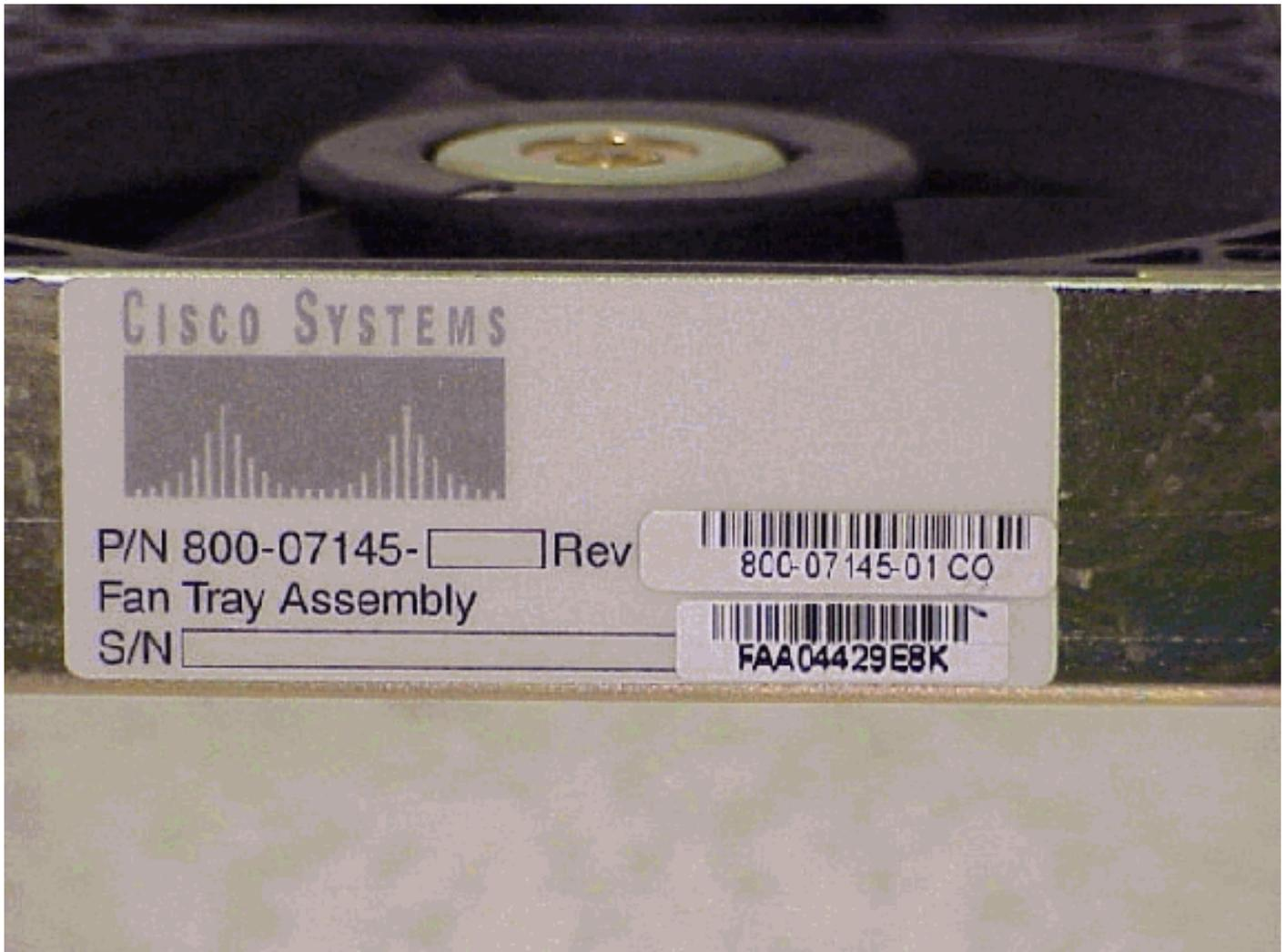
**Hinweis:** Bei älteren Lüftereinschüben (vor Cisco) befindet sich das Serien- oder Teilenummernetikett auf dem Blech auf der Vorderseite des Lüftereinschubs. Das Format der Seriennummer oder Teilenummer unterscheidet sich von dem Format der Cisco-Assembly. Die Seriennummer besteht aus sechs Ziffern (z. B. 123456), und die Teilenummer beginnt mit der Nummer 87 oder 89 (z. B. 89-01-0004). In diesem Feld sind nur wenige dieser Assemblys enthalten.
